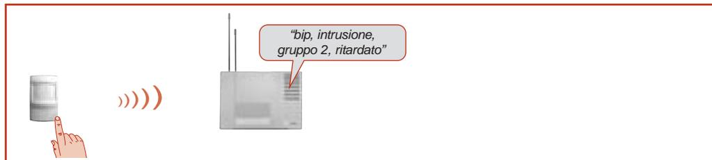
❑ Per i 90 secondi successivi alla pressione del pulsante di test, il rivelatore d'apertura rimane in modo test: ogni volta che rileva un movimento all'interno della sua area di copertura, accende la spia luminosa rossa per alcuni secondi e trasmette alla centrale; in questo modo potete verificare facilmente il buon funzionamento del rivelatore.
