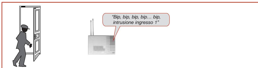
In caso di rilevazione da parte di un rivelatore di movimento abbinato al Gruppo 1, la centrale comunica: **"Bip, bip, bip, bip... bip, intrusione rivelatore x"**.
