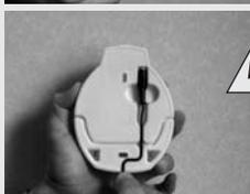
Avvitare il supporto a parete. Collegare il blocco alla rete elettrica (220 V) (riposizionate il coperchietto sul supporto).
