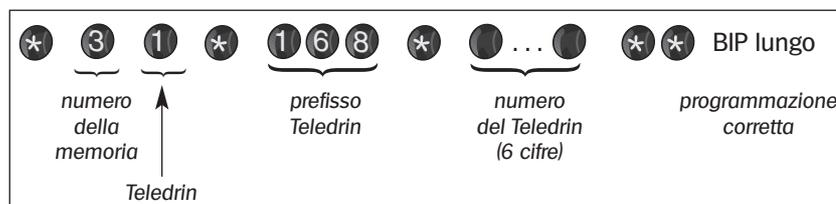
Al momento della chiamata, il tipo di allarme indicato dalle ultime 3 cifre (vedi tabella a pag. 5) sarà automaticamente trasmesso ed apparirà sul display del Teledrin.
