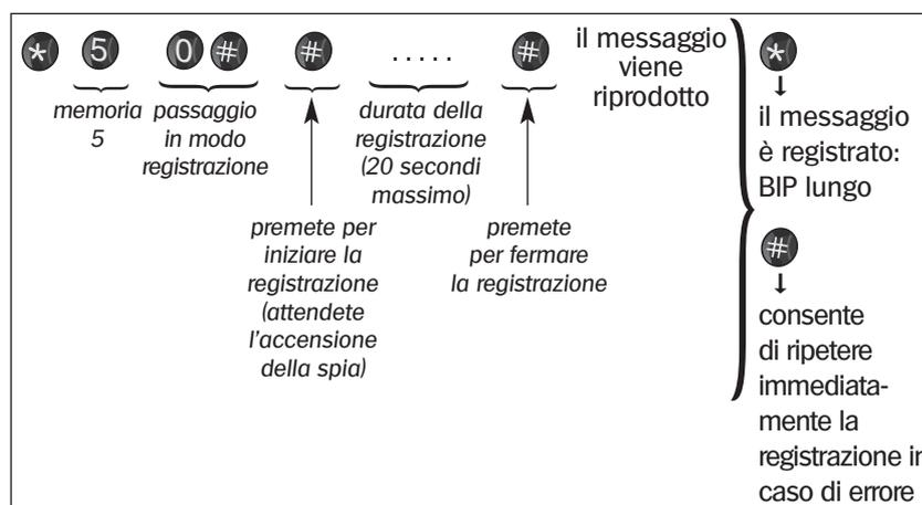
● La spia luminosa del combinatore si accende per segnalare l'inizio della registrazione del messaggio vocale, inizia a lampeggiare dopo 15 secondi per segnalare che il periodo di registrazione sarà interrotto entro 5 secondi.
