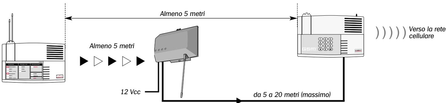
Alla ricezione di un segnale d'allarme, il ricevitore attiva l'uscita corrispondente che mette in funzione il combinatore telefonico. L'autoprotezione ed il controllo tensione del combinatore telefonico GSM sono sempre attivi.
