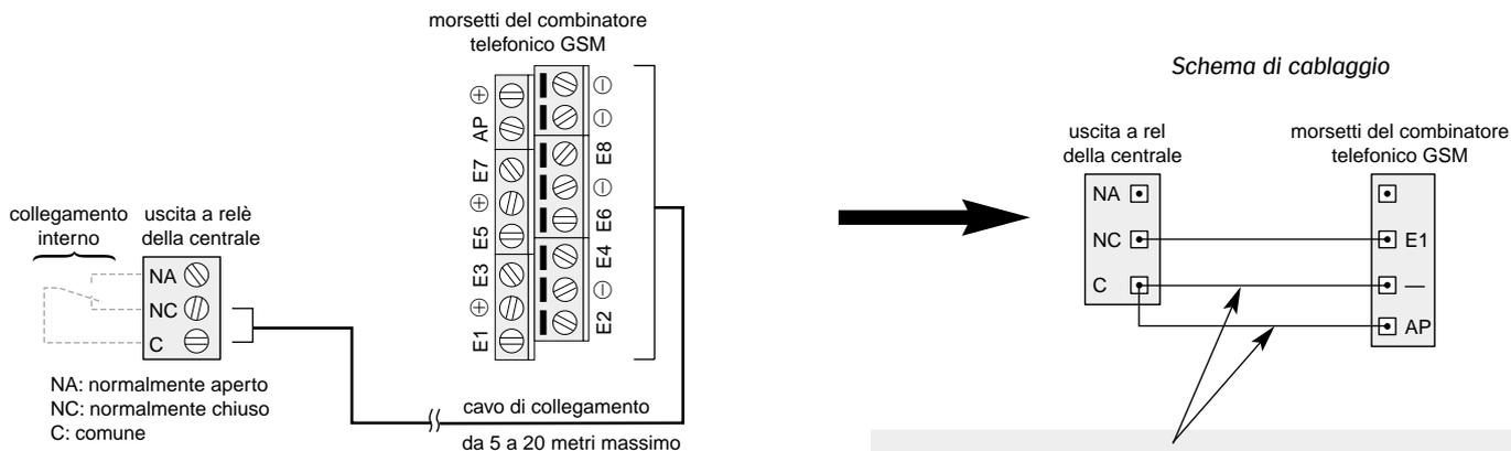
Collegamento da effettuare esclusivamente se si desidera proteggere il combinatore telefonico GSM contro un tentativo di taglio del cavo di collegamento. In questo caso, è necessario rimuovere il ponticello che collega gli ingressi "AP" e "-".
