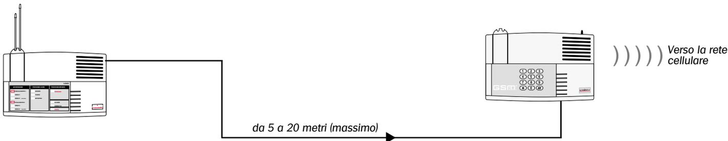
In caso d'allarme, l'uscita relè della centrale attiva l'ingresso E1 del combinatore cellulare GSM. L'autoprotezione ed il controllo tensione del combinatore telefonico GSM sono attivi.
