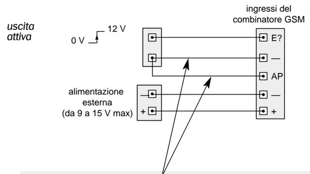
(\*) Collegamento da effettuare esclusivamente se si desidera proteggere il combinatore telefonico GSM contro un tentativo di taglio del cavo di collegamento. In questo caso, è necessario rimuovere il ponticello che collega gli ingressi “AP” e “-”.
